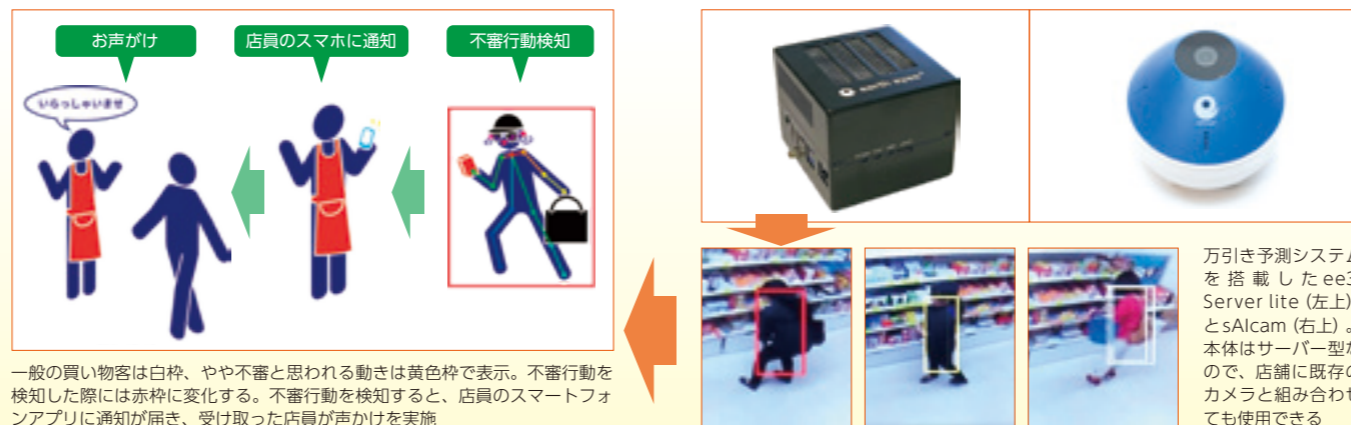
左右の手で品物を持つ、移動させる、離すなどの動きを検知。意図しないレジスルーも含めて、不自然な動きがあればアラートを出す
